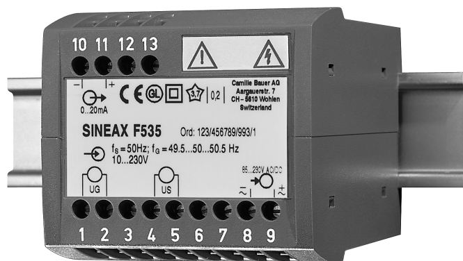
Obr. 1: Převodník SINEAX F 535 upevněný na liště DIN 35 mm
