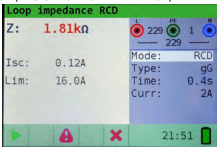
Abb. 15: Zkouška impedance poruchové smyčky RCD, zapojení a výsledky
